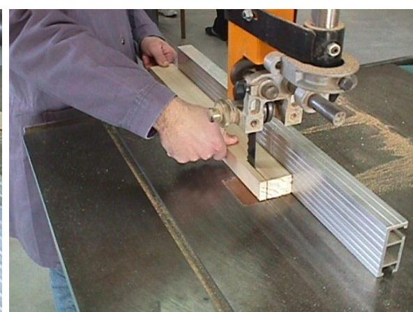
**Različite metode sečenja tračnom testerom: Sečenje po debljini (levo) i sečenje po širini (desno)**
