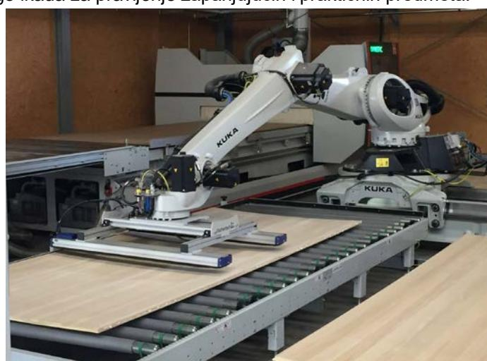
**Automatska robot mašina za mašine za preradu drveta**
