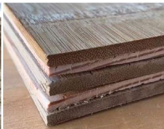
Slike 1-2. Bambus kao alternativa drvnoj građi. Niti od bambusa (levo) i laminirani hibridni kompozit od bambusa (desno) (izvor: [www.wbpionline.com](http://www.wbpionline.com), <https://worldbamboo.net>)
